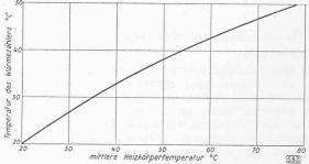
Bild 5. Temperatur des Wärmezählers in Abhängigkeit von der mittleren Heizkörpertemperatur
