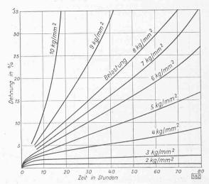
Bild 3. Zeit-Dehnungsdiagramm für Z 100 A  $(0.4 \, \%)_0$  Cu,  $0.94 \, \%)_0$  Al,  $0.004 \, \%)_0$  Cd, Rest Zn)
