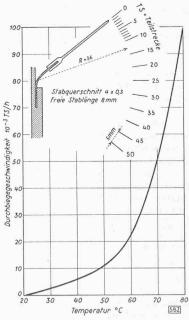
Bild 7. Gemessene Durchbiegungsgeschwindigkeit des Heizkostenverteilers
