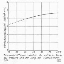
Bild 6. Wärmedurchgangszahl eines normalen Heizkörpers in Abhängigkeit der Temperaturdifferenz zwischen Heizwasser und Luft
