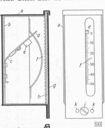
Heizkörper befestigt ist. Es enthält den Skalenträger b mit der Skala f und ist vorn durch den Dekkel g mit einer Scheibe h aus Plexiglas dicht abgeschlossen. Der Deckel wird mit der Verschlusschraube i am Gehäuse befestigt, die plombiert werden kann, um unbefugtes Oeffnen zu verhindern.
