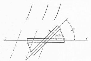
Bild 22. Drei Aufnahmen der Schwingungsrichtung am Schaufelkopf für das Seitenvernältnis 10/1 und 45° Verdrillung. Die Erregungsrichtung EE fällt wie bei den Bildern 20 und 21 mit der 2. Hauptträgheitsaxe des Fussquerschnittes zusammen. Die Schwingungsrichtung ist gegen sie um  $69^{1}/_{2}$ ° verschoben. Die Schwingungsform ist eine schwach gekrümmte Kurve.
