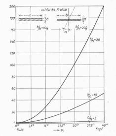
Bilder 1 und 2. Abhängigkeit des Trägheitsmomentes eines Rechteckquerschnittes, wenn die Schwingungsrichtung S-S von der Trägheitshauptaxe um den Winkel  $\alpha$  abweicht
