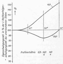
Bild 14. Aenderung der I. Hochkanteigenfrequenz bei verwundenen unverjüngten Stäben, abhängig von der Verwindung des Kopfquerschnittes gegen den Fussquerschnitt
