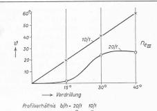
Bild 13. Verschiebung der Schwingungsrichtung um den Winkel  $\delta$  bei unverjüngten verdrillten Stäben und verschiedenen Eigenfrequenzen, abhängig von der Verdrillung
