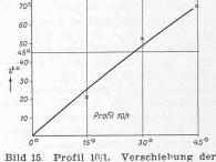
Bild 15. Profil 10/1. Verschiebung der Schwingungsrichtung um den Winkel  $\delta$  bei der Hochkanteigenschwingung bei unverjüngten verdrillten Stäben, abhängig von der Verdrillung
