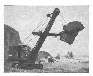
Löffelbagger mit Tru-Lay-Brugg-Drahtseilen ausgerüstet
