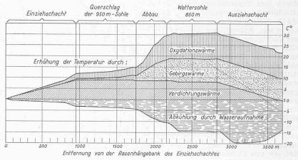
Bild 38. Temperaturverlauf der Wetter unter Tage
