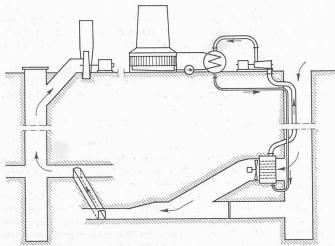
Bild 39. Kaltdampf-Kühlanlage für Grubenkühlung
