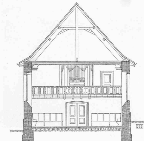
Bild 2. Renoviertes Kirchlein Fluntern, Querschnitt 1:200
