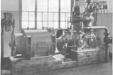
Kompressor, angetrieben durch Combi-Motor 95 kW, 380 V, 50 Hz.
