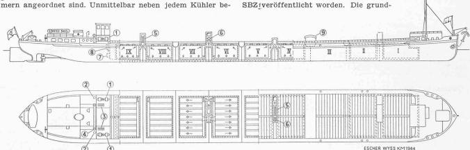
Das Motorkühlschiff «Sonvico» der Schweizerischen Reederei A.-G. I, II, IV, V, VI, VII, VIII und IX Kühlkammern, III nicht gekühlter Laderaum, 1 Kältekompressor «Rotasco», 2 Oelabscheider, 3 Oelkühler, 4 Kondensator, 5 Luftkühler, 6 Ventilator, 7 Kühlwasserpumpe, 8 Schalttafel, 9 Diesel-elektrische Bordzentrale
