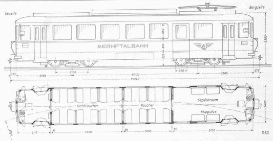
Bild 4. 400 PS-Motorwagen der Sernftalbahn (vgl. SBZ 1949, Nr. 28, S. 392\*), Typenskizze 1:120
