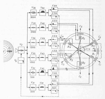
Bild 2. Prinzipschema des phonetischen Steno-Sonographen von J. Dreyfus. Bezeichnungen im Text
