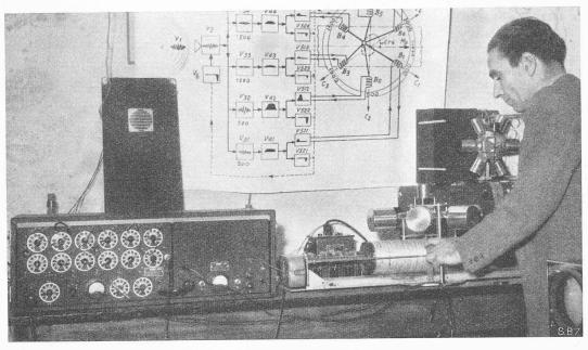
Bild 3. Der phonetische Steno-Sonograph bei der Inbetriebsetzung Rechts mechanischer Teil mit Schreibgerät auf Trommel, darunter auf Papierband
