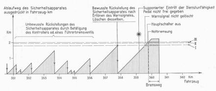
Bild 7. Ausschnitt aus einem Ablaufdiagramm des Sicherheitsapparates. I 1,8km Ablaufweg: Ertönen des Warnsignals, II 1,95km Ablaufweg: Hauptschalter aus, III 2,0km Ablaufweg: Notbremsung
