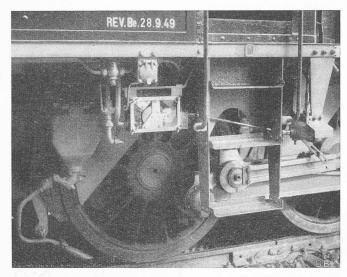
Bild 5. Probeapparat auf der Lokomotive Ce % III No. 14315 der SBB. Inneres durch Verschlussdeckel aus Plexiglas sichtbar
