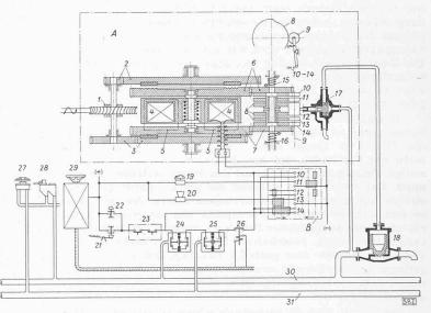
Bild 4. Prinzipschema der Sicherheitssteuerung mit selbsttätiger Wachsamkeitskontrolle, System Maschinenfabrik Oerlikon
