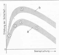
Bild 1. Gruppierung der Ursachen der bei dienstunfähigem Führer durch Sicherheitssteuerungen verhütbaren Zugunfälle und Wirkungsbereich verschiedener Pedalanordnungen. 1 Gewöhnliches Pedal, 2 Verschaltes Pedal für Vorderfuss, 3 Nähmaschinenpedal, 4 Pedal, in Zeitabständen kurzzeitig freizugeben, 5 Pedal in Verbindung mit der neuen Sicherheitssteuerung
