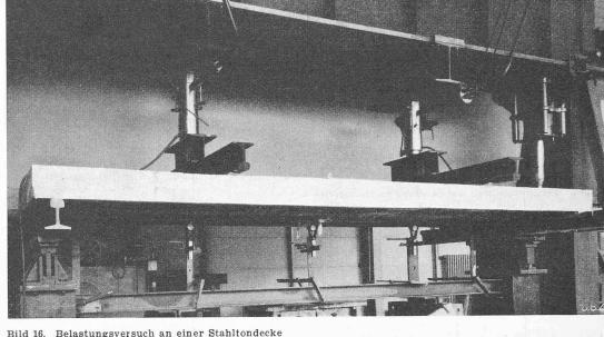
Belastungsversuch an einer Stahltondecke
