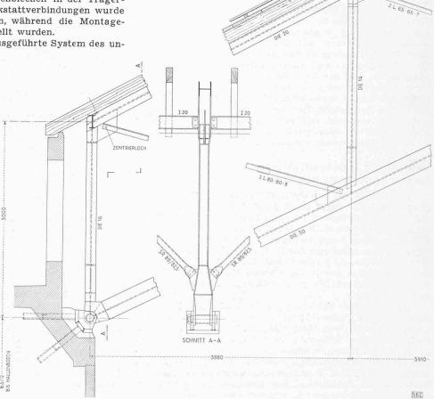
Bild 7. Bogenbinder, Endfeld mit Widerlager, Masstab 1:50
