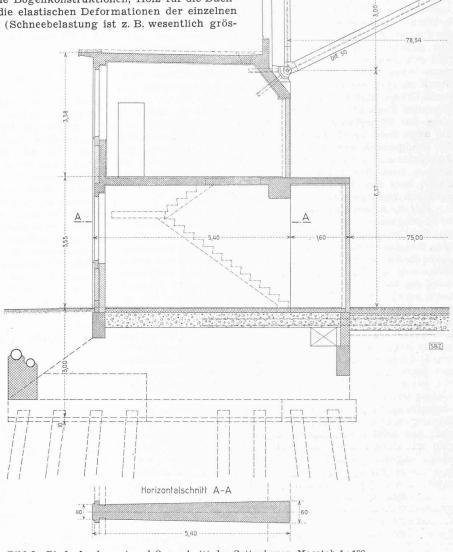
Bild 5. Binderfundament und Querschnitt des Seitenbaues, Masstab 1:100
