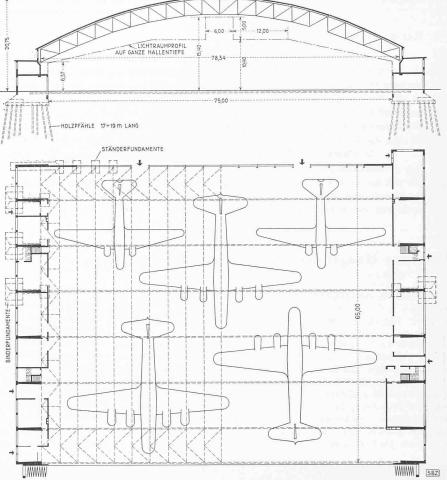
Bilder 2 und 3. Querschnitt und Grundriss der Halle, Masstab 1:800
