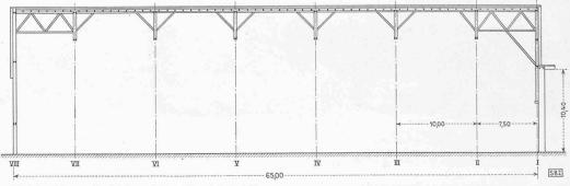
Bild 4. Längsschnitt der Halle, Masstab 1:500
