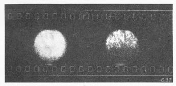
Bild 10. Schallbilder fehlerhafter Bindungen in einer bleiplattierten Stahlplatte: links befriedigende Bindung, rechts flockige, fehlerhafte Bindung mit grosser Störung, die das halbe Gesichtsfeld überdeckt
