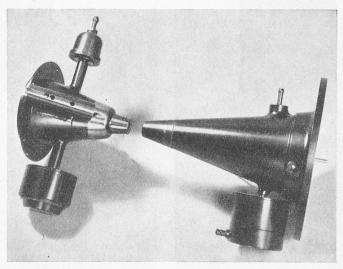
Bild 6. Rüsselvorsätze zur Untersuchung schwer zugänglicher Schweisspunkte
