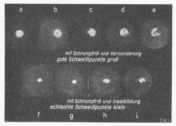
Bild 8. Schallabbildungen von Leichtmetallschweisspunkten. Punkt b zeigt in der Mitte einen Schrumpfriss, die Punkte c, d, e zeigen Verzunderung
