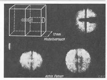
Bild 11. Schallabbildung einer Spaltebene parallel zur Durchstrahlungsrichtung. Oben: Modellversuch; unten fehlerhafte Stumpfschweissungen
