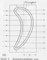
Durchleuchtung gekrümmter Objekte (z. B. Turbinenflügel usw.)
