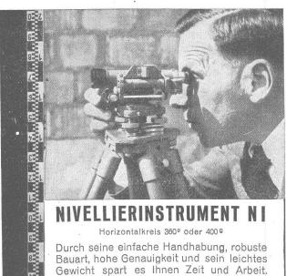
$\begin{array}{ccc} \mbox{H\"ohenfehler auf 1 km} & \pm 5 \mbox{ mm} \\ \mbox{Fernrohrvergr\"osserung} & 18 \times \\ \mbox{K\"urzeste Zielweite} & 1,60 \mbox{ m} \\ \mbox{Gewicht des Instrumentes} & 1 \frac{1}{2} \mbox{ kg} \end{array}$
