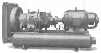
Luftgekühlter SLM-Chassis-Kompressor, Leistung 35 PS
