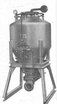
Betonier-Pneumatic zur hydraulischen Betonförderung
