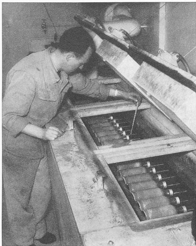
Bild 8. Ansicht des Plasmagefrierapparates mit geöffnetem Deckel
