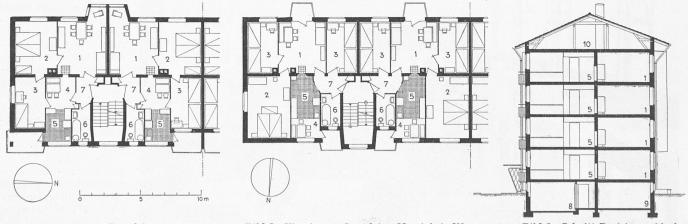
Bild 6. Dreizimmer-Grundriss Bild 7. Vierzimmer-Grundriss, Masstab 1:300 Bild 8. Schnitt Dreizimmerblock Legende: 1 Wohnzimmer, 2 Eltern, 3 Kinder, 4 Essplatz, 5 Küche, 6 Bad und WC, 7 Vorplatz, 8 Waschküche, 9 Abstellraum, 10 Estrich
