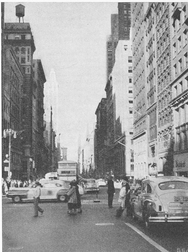
Bild 5. Kreuzung an der sechsspurigen Fifth Avenue, New York. Einfache Lichtsignalanlagen (vier Ständer mit je drei Lampen), während Spitzenzeiten durch Polizisten unterstützt. Die Zahl der Fussgänger ist in Manhattan derart gross, dass sie die Strasse überall kreuzen dürfen; nur auf Kreuzungen beschränkt, würden sie den Verkehr zu stark stören, deshalb fehlen Fussgängerstreifen
