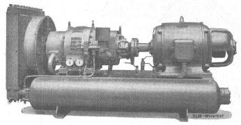
Luftgekühlter SLM-Chassis-Kompressor, Leistung 35 PS
