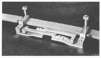
Bild 4. Krümmungsmesser für Zelluloid-Modelle (Typ III von Bild 7. Modell eines Trägerrostes aus 6 Hauptträgern und 4 Querträ-Bild 1) zur Messung der Verformungen mit Hilfe eines Mess-Mikroskopes eingerichtet. momentes im Hauptträger-Querschnitt durch Anhängung einer Einzellast nacheinander an allen Knotenpunkten
