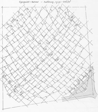
Bild 13. Ergebnisse des Modellversuches: Momentenflächen der Roststäbe für Eigengewicht, gleichförmig verteilte Nutzlast
