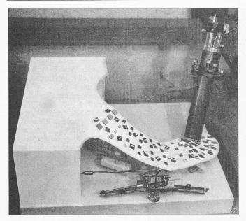
Bild 18. Modell der geschweiften Treppe «Selve» aus «Engl. Zement», Masstab 1:20. Die Lasten sind mittels Hebel-Uebertragung entsprechend dem Bauwerk verteilt. Optische Verdrehungsmessungen Bild 19 (unten). Ergebnisse der Modell-Messungen: Richtung und Grösse der Hauptmomente; Bewehrungsrichtungen
