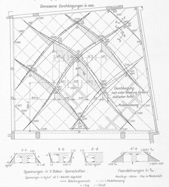
Bild 15. Geschäftshaus «Bären», Trägerrost-Decke. Belastungsversuche vom 22. Juni 1948. Belastung: 4 Lastwagen,  $\Sigma P=50.8$  t, Durchbiegungen und Faserdehnungen, am Bauwerk gemessen und aus den Messungen am Modell auf das Bauwerk übertragen
