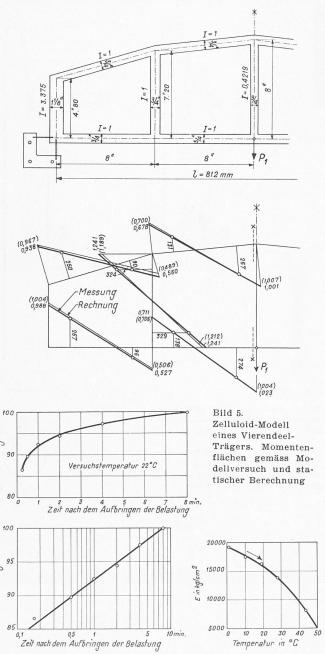
Bild 6. Elastische Eigenschaften des Materials des auf Bild 5 dargestellten Modells. Beachte die starke Abhängigkeit des Elastizitätsmoduls von der Temperatur und das grosse Kriechmass!
