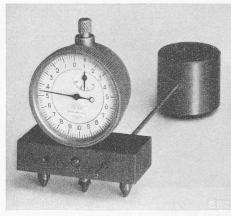
Bilder 2. Krümmungsmesser von 40 mm Messlänge mit\_Messuhr von 1/1000 mm Anzeigegenauigkeit
