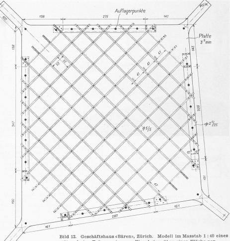
Bild 12. Geschäftshaus «Bären», Zürich. Modell im Masstab 1:40 eines stützenfreien Trägerrostes aus Eisenbeton über einer Fläche von  $22.0\times24.0$  m. Material: Leichtmetall, verschraubt. Roststäbe  $5\times5$  mm
