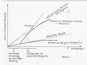
Ueber die Frage der Grösse von  $f_0$  dürften folgende Annahmen für die Berechnung massgebende Werte liefern: Eine für alle Querträger gleichmässige Belastung ergibt  $f_0 = 0$ . Zu vergleichen sind: Ein oder zwei oder drei belastete Querträger und unbelastete Nachbar-Querträger. Als Querträgerbelastung ist anzunehmen die auf diesen Querträger fallenden grösstmöglichen Axlasten plus 100  $^0/_0$  Stosszuschlag.
