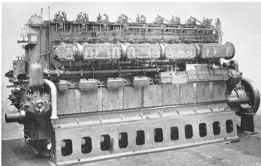
Bild 4. Rheinschlepper «Unterwalden». Einer der vier Sulzer-Zweitakt-Dieselmotoren von 1000 PS bei 340 U/min. Ansicht von der Auspuffseite, rechts unter der Auspuffleitung die Brennstoff-Einspritzpumpen
