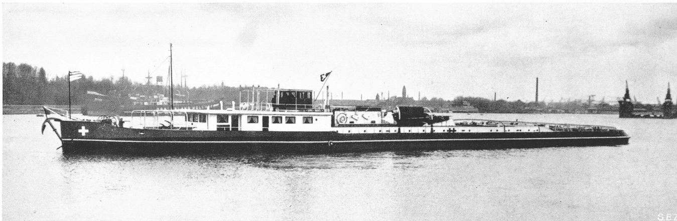
Bild 3. Das Rhein-Motor-Schleppschiff «Uri» der Schweizer. Reederei A.-G. in Basel mit vier Sulzer-Dieselmotoren von zusammen 3600 PS bei 350 U/min. Das Schleppschiff «Unterwalden» sieht äusserlich genau gleich aus
