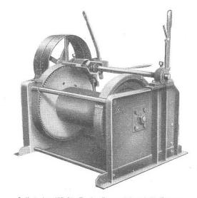
Seilwinden KS für Zugkraft von 1,5 und 2,5 Tonnen
