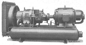
Luftgekühlter SLM-Chassis-Kompressor, Leistung 35 PS
