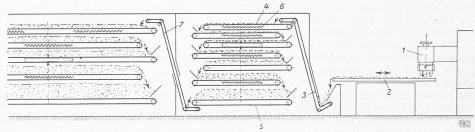
Bild 8. Prinzipschema eines Bandtrockners für Kurzwaren. 1 Teigwarenpresse, 2 Schüttelsieb, 3 Elevator, 4 oberes Transportband, 5 unteres Transportband, 6 Lufterhitzer, 7 Elevator
