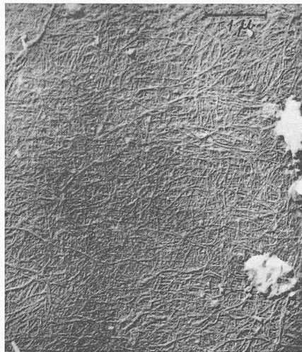
Bild 2. Flachsfaser Streuungstextur der Primärwand
