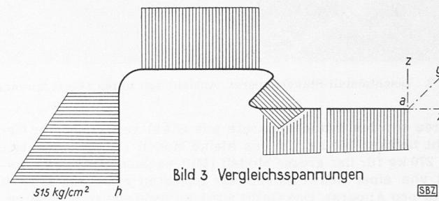
Bild 3 Vergleichsspannungen
