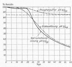
Bild 1. Haltbarkeit wässriger Lösungen mit 5000 E Penicillin/cm³ bei + 4°C
