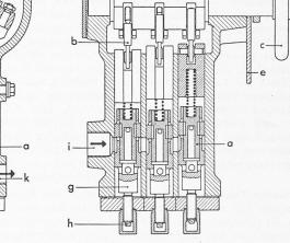
$\operatorname{Bild} 2.$  Steuerorgan eines fernbedienten, dreistufigen Kompressors mit Sulzer-Staudüsenregelung
