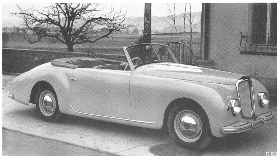
Cabriolet, schweiz. Spezialkarosserie auf Rover-Chassis. Sorgfältig ausgewogene Form ohne Uebertreibung, zweckmässige Anordnung der verchromten Schutzleisten Hersteller Carosserie Graber, Wichtrach-Bern
