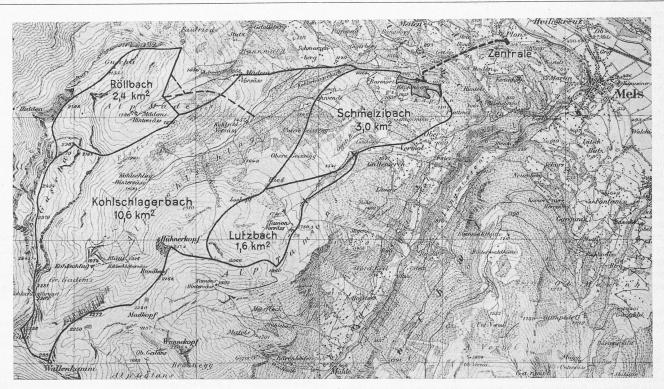
Bild 1. Einzugsgebiet des Kraftwerks Plons-Mels, 1:60000. Die Ueberführungsstellen des Lutzbaches in den Schmelzibach sind mit 🗙 bezeichnet; Reproduktion und Veröffentlichung der Siegfriedkarte 1:50 000 in verkleinertem Masstab mit Bewilligung der Eidg. Landestopographie, Techn. Dienst, Wabern bei Bern
