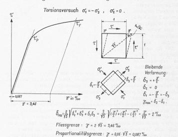
Bild 13b. Vergleichsdehnung  $\delta_{\mathrm{res}}$  bei reinem Schub
