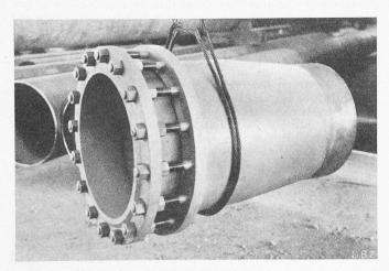
Bild 10. Expansionsstück von 500 mm Nennweite und für 52 at Betriebsdruck im Werk der Firma Wild in Muri
