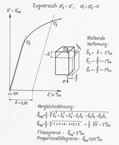
Bild 13a. Vergleichsdehnung  $\delta_{\text{res}}$  bei einaxigem Zug
