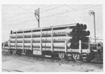
Bild 12. 18 Rohre für die Druckleitung von insgesamt 39599 kg auf einem Spezialwagen der SBB auf der Station Mels
