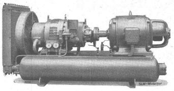
Luftgekühlter SLM-Chassis-Kompressor, Leistung 35 PS
