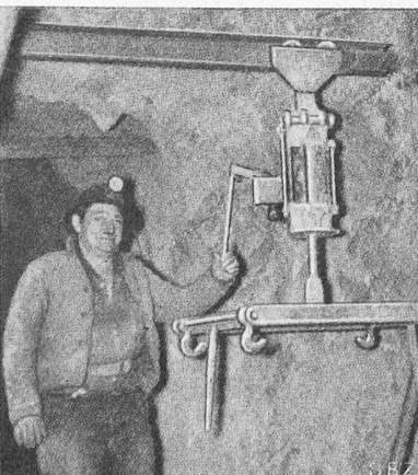
Bild 15. Laufkatze mit Druckluftzylinder
