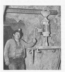
Bild 15. Laufkatze mit Druckluftzylinder
