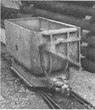
Bild 10. Rollwagen amerikanischer Konstruktion mit 2,0 m 3 Inhalt
