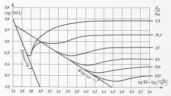
Bild 2. Nikuradse's Diagramm des Widerstandsbeiwerts mit Reynolds'scher Zahl:  $Re'=v~R_{\delta/\nu}$  und reziproker relativer Rauhigkeit  $R_{\circ}/d_{90}$
