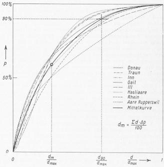
Bild 3. Kornverteilungskurven (Relativwerte) einiger Flüsse
