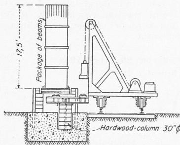
Schalungen für 33 stehend zu betonierende T-Balken sind zu einem Prisma von etwa  $1,05 \times 1,05$  m Querschnitt und 5,25 m Höhe zusammengefasst und durch drei Horizontalrahmen fest verspannt. Das Prisma seinerseits steht exzentrisch auf einem durch ein Holzpfieberchen unterstützten Boden; auf der
