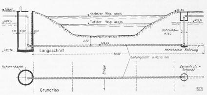
Bild 16. Der Düker unter der Broye bei Bellechasse, 1:400
