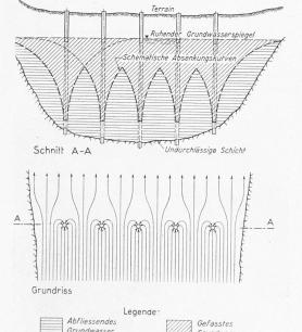
Schematische Darstellung der Fassung eines schmalen Grundwasserstroms:
