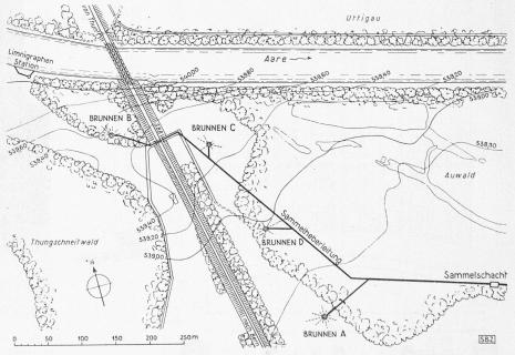
Bild 2. Lage der Brunnen im Fassungsgelände des Aaretal-Grundwasserwerks bei Kiesen. Kurven des Grundwasserstandes am 8. Mai 1947. Masstab 1:6000
