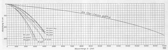
Bild 7b. Brunnen D in Kiesen: Ertrag der einzelnen Filterrohre und des ganzen Brunnens
