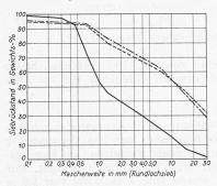
— Siebkurve des Bohrgutes der Horizontalbohrungen, Brunnen D ——— Siebkurve des Grundwasserträgers Brunnen D, Kote 527,36 m —— Siebkurve des Grundwasserträgers Brunnen D, Kote 529,00 m
