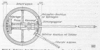
Bild 3. Schema der Horizontalbohrungen, Masstab 1:100
