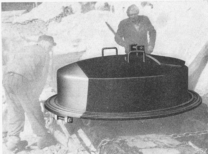
Bild 7. Als Schwimmkörper ausgebildeter Abschlussdeckel
