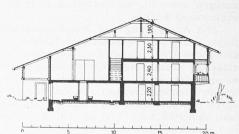
Bild 2. Grundrisse und Längsschnitt wie Bild 1. Masstab 1:400. Stall und Heubühne sind im linken Teil des Hauses untergebracht, die Wohnräume befinden sich rechts
