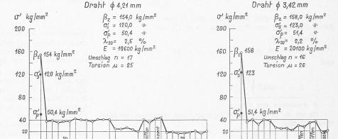
Bild 16. Dauerbiege- und Dauertorsionsversuche mit Stahldrähten (eine Million Lastwechsel)
