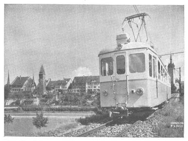
Einer der drei neuen Motorwagen der Bremgarten - Dietikon - Bahn. Stundenleistung 460 PS, max. Geschwindigkeit 65 km/h. Die handbetätigten Vielstufen - Direktkontroller ergeben einfachste, betriebssichere elektrische Ausrüstung und minimalen Unterhalt.
