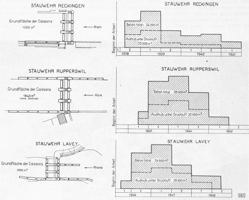
Bild 21. Vergleich der Wehranlagen dreier schweizerischer Flusskraftwerke hinsichtlich Arbeitsumfang und Bauzeit
