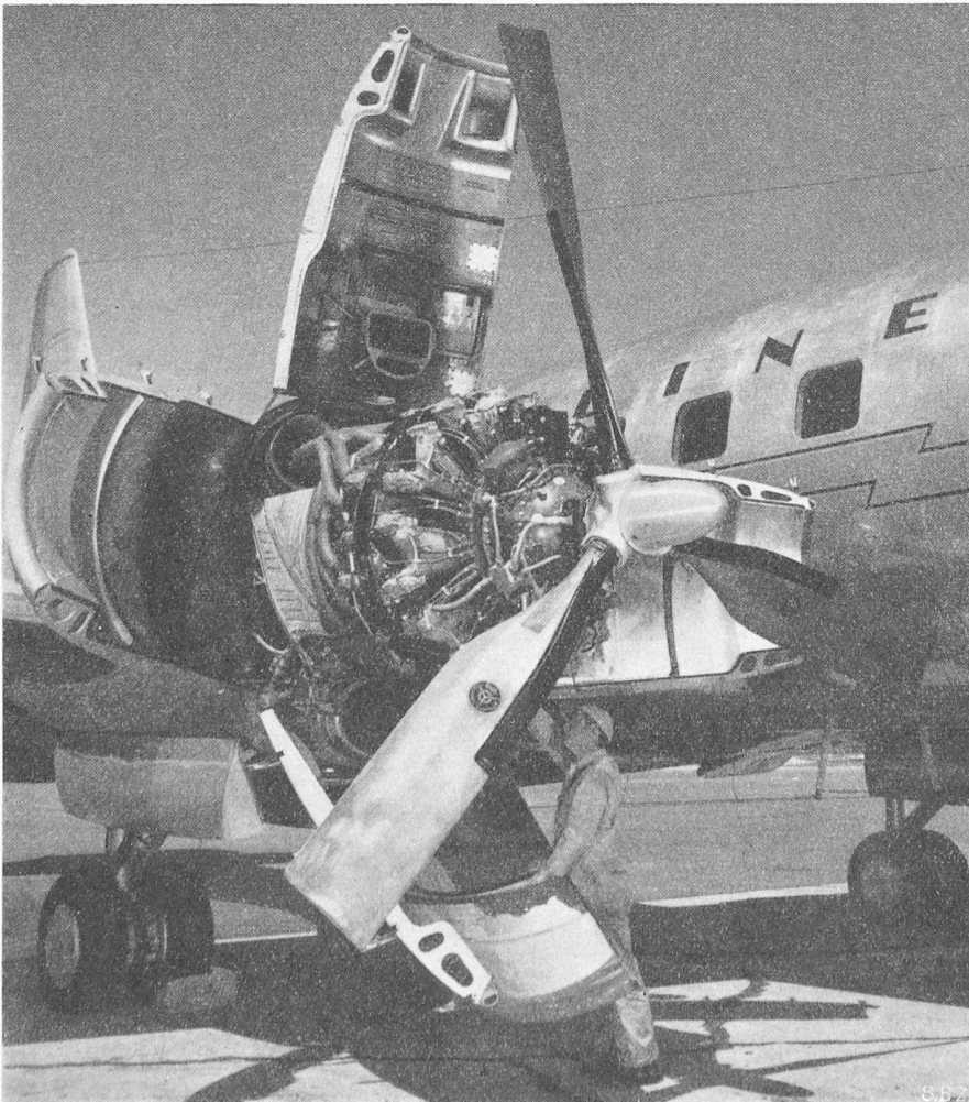
Bild 3. Motorgondel mit aufgeklappter Verschaltung
