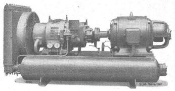
Luftgekühlter SLM-Chassis-Kompressor, Leistung 35 PS
