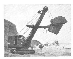
Löffelbagger mit Tru-Lay-Brugg-Drahtseilen ausgerüstet
