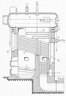
stehende Bild zeigt den Längsschnitt eines Kleinst-Teilkammerkessels, Bauart Dürr, für 700 kg/h Normallast und 350 °C Dampftemperatur, mit Speisewasservorwärmer für Wassererwärmung auf 130 °C (a Speisewassereintritt, b Speisewasservorwärmer, c Trommel,  $d_1$  vordere Teilkammer,  $d_2$  hintere Teilkammer, e Siederohre, f Sattdampfsammler, g Dampfüberhitzer, h Heissdampfsammler, i Heissdampfaustritt, k Planrost).
