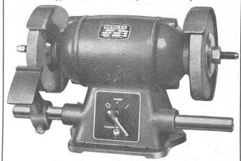
Leistung 1/3 PS bei Drehstrom 1/4 PS bei Einphasen-Wechselstrom Drehzahl 3000 T/Min, im Leerlauf Scheibendurchmesser 125 mm Komb. Ausführung zum Schleifen und Polieren
