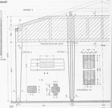
Bild 34. Rahmenbinder I; Masstab 1:50, Details 1:25
