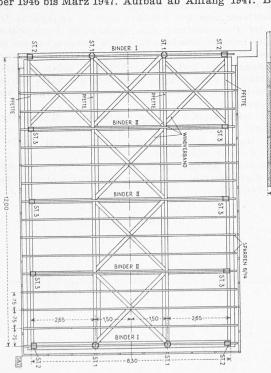
Bild 32. Boldern. Holzkonstruktion des grossen Saals, Grundriss  $\mathbf{1}:150$
