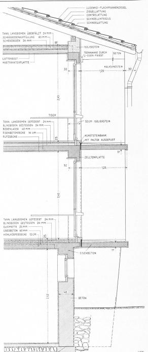
Bild 5. Haupthaus, Fassadenschnitt des Zimmertrakts. Masstab 1:50
