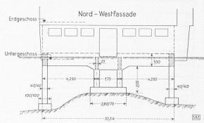
Bilder 30 und 31. Boldern, Haupthaus, Schema der Eisenbeton-Fundation 1:200. Text siehe Seite 12
